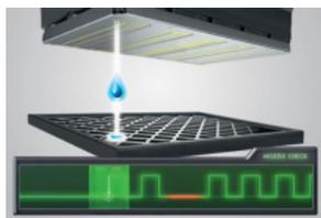
Die Epson AID-Technologie nutzt einen Sensor in der Nähe des Druckkopfs, der die elektrische Ladung eines jeden Tintentropfens misst, um zu ermitteln, ob eine Düse verstopft sein könnte. Wenn nötig, startet der Drucker automatisch einen Reinigungszyklus und ist nach einigen Sekunden wieder druckbereit. So wird eine maximale Genauigkeit bei den zentralen Elementen der Etiketten erzielt, z. B. Barcodes und Farbcodes.
