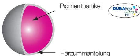
Die Drucke sind mit unserer Pigmenttinte strapazierfähig. Die Tinte wird auf der Oberfläche der Medien aufgetragen und ist dank ihrer Harzummantelung sehr widerstandsfähig gegen Licht, Wasser, Feuchtigkeit und Ozon.
