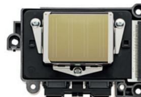
Epson MicroPiezo-Tintenstrahl drucker tragen die Tinte mittels elektrischer Ladungen statt Wärme auf, sodass eine exakte Steuerung der Größe und Platzierung der Tröpfchen ermöglicht wird. Durch Tröpfchen von nur 3,5 Pikoliter werden Qualität und Schärfe erheblich verbessert. Zudem trägt dieses System zur Kosteneindämmung bei, da der Druckkopf ebenso lange genutzt werden kann wie der Drucker selbst.
